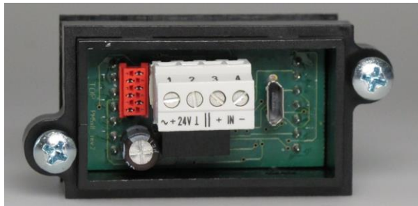
Befestigung X1:Versorg. Eing. X3:Micro-USB (Typ B)
