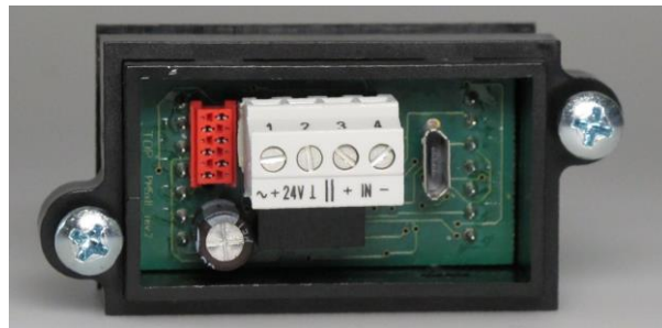
Befestigung X1:Versorg. Eing. X3:Micro-USB (Typ B)
