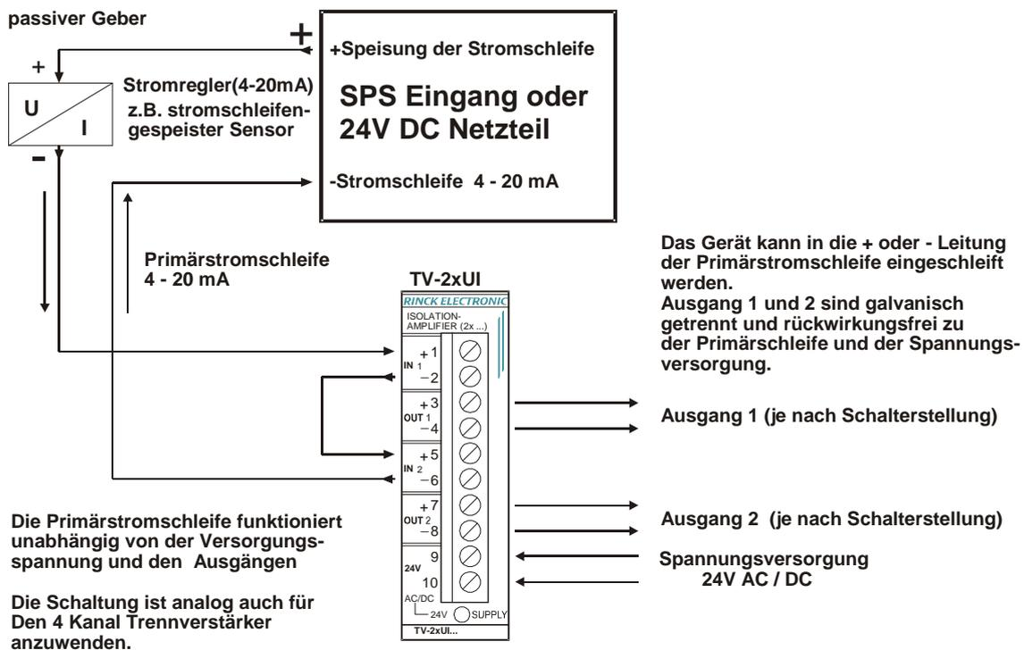
Bei dem Universal-Trennverstärker TV-XxUI können die Eingangsbereiche und die Ausgangsbereiche je Kanal mit dem zugehörigen 16-stelligen Drehschalter an der Rückseite frei gewählt werden, siehe das Datenblatt **B050**. Die LC-TV...Trennverstärker haben feste Eingangsbereiche und Ausgangsbereiche, siehe die zugehörigen Datenblätter.
