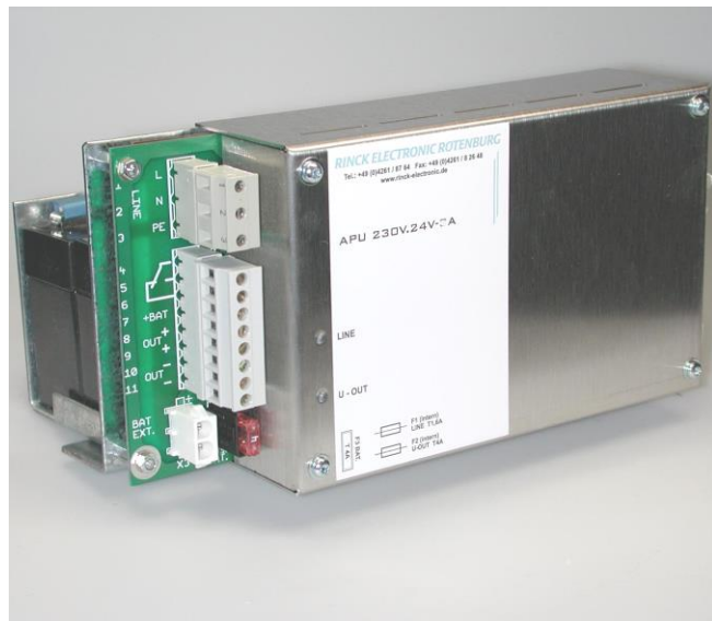
APU 230V.24V-3A/2,2Ah/TS Kompaktversion mit Akkusatz, zum Aufsnappen auf Hutschiene TS 35.
