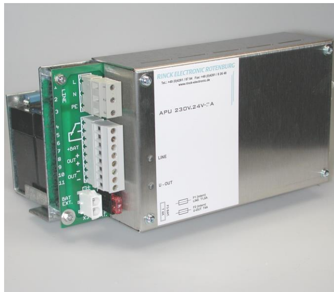
APU 230V.24V-2A/2,2Ah/TS Kompaktversion mit Akkusatz, zum Aufschnappen auf Hutschiene TS 35.
